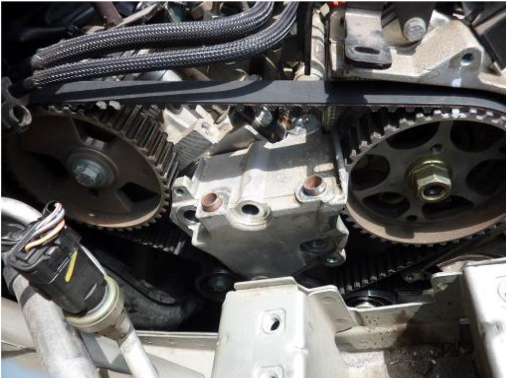
En cas de défaut de **remplacement de la courroie de distribution**, celle-ci avec l'usure peut se rompre et endommager irrémédiablement votre moteur, rappelez-vous de son rôle de *coordination du vilebrequin, des soupapes* et de l'*arbre à cames*. En cas de **rupture de la courroie de distribution** ce sont ces éléments qui seront touchés en premier et qui rendront votre véhicule inutilisable. Dans ce cas de figure la seule option qui vous restera consistera au changement complet du moteur.
